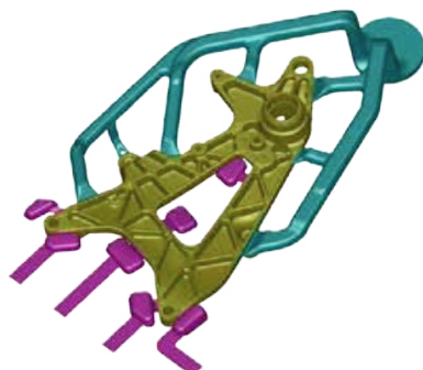
モーター・サイクル部品のゲート・システム
